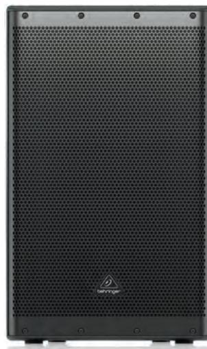
due i canali combo con volumi separati + ingresso per segnale bluetooth (o Aux In su minijack), Output XLR e un DSP per l'impostazione di 4 programmi di riproduzione (Music, Live, Speech e DJ/Club), per l'eq, il filtro low-cut, il controllo del sistema di protezione e la gestione bluetooth. Il sistema, configurato con woofer da 15" e tweeter da 1,75", ha risposta in frequenza 45 Hz - 19 kHz e SPL massima di 136 dB di picco. Peso: 21,4 kg.
