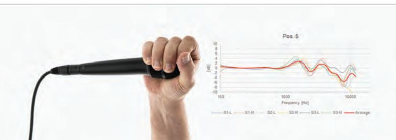
La mano circonda la testa del microfono, il che rende le risonanze più distinte. La risonanza maggiore si trova intorno ai 2 kHz; tuttavia, a circa 3-4 kHz si creano anche risonanze dovute alla cavità creata dalla mano davanti al microfono.
