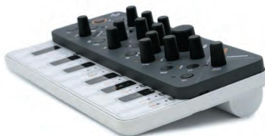
lanciato su Kickstarter e segue i modelli di fascia alta 002, 008 e 001 e DIY CRAFTsynth. Oltre a quattro voci polifoniche, il motore audio di Skulpt è composto da 32 oscillatori - otto per voce con due forme d'onda morphable. Sebbene abbia solo una tastiera a 16 tasti, vanta sequencer, matrice di modulazione, filtro, delay e distorsione.
